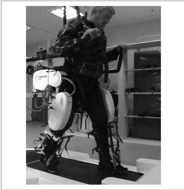
Рис. 1. Роботизированное ортопедическое устройство Lokomat.
